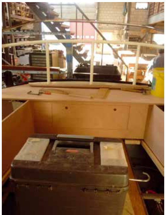
Opbouw en binnenkant stuurhut schuren, plamuren, gronden en lakken, zodat de ramen erin kunnen en de stuurtent klaar is voor de nieuwe kisten, vloer en Morsehendel.
