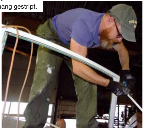
Opbouw en binnenkant stuurhut schuren, plamuren, gronden en lakken, zodat de ramen erin kunnen en de stuurtent klaar is voor de nieuwe kisten, vloer en Morsehendel.
